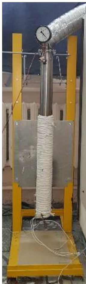
Рисунок 89 – Фотография экспериментального стенда для исследования процессов захлаживания расплава ТЖМТ при взаимодействии с инертным газом (рабочий участок с вакуумной теплоизоляцией).
